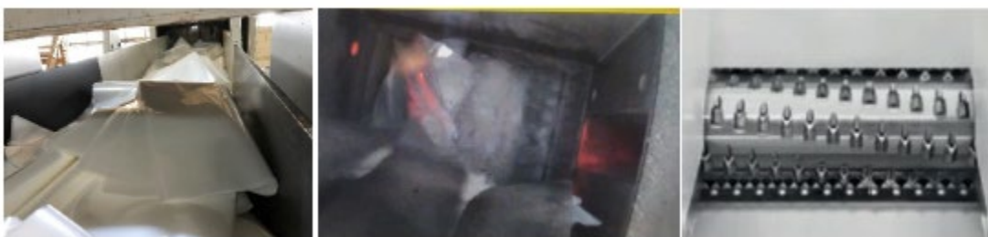
Abb. 25: S Gran 95 Impressionen (von links: Materialzufuhr, Schneidwerk, Schnecke)
