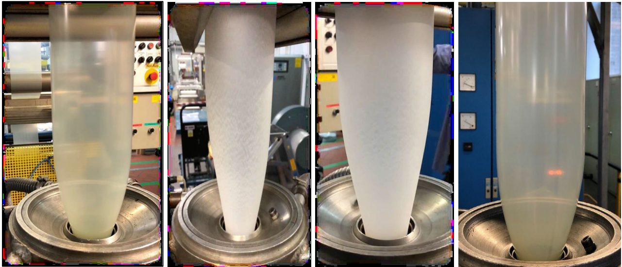
Abb. 29a–d: Optik der Monofolienblase (Schmelztemperatur):
